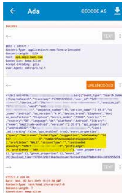
Ada 2.49.0 übermittelte Symptombeschreibungen (hier „Herzrasen“) an Amplitude. Die Übertragung protokollierten wir mit Packet Capture.
