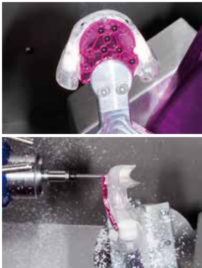
Abb. 6 und 7: Umbau der Röntgenschiene in eine Bohrschablone über patentiertes, Nullpunkt-gespanntes Haltersystem dentaler Fräsmaschinen
