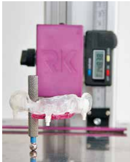
Abb. 8 und 9: Vermessung der finalisierten Implantat-Bohrschablone mit einem kalibrierten Prüftisch in der X-, Y- und Z-Achse, dem Durchmesser und dem Tiefenanschlag bezogen auf das Hülsensystem sowie Erstellung eines Prüfprotokolls
