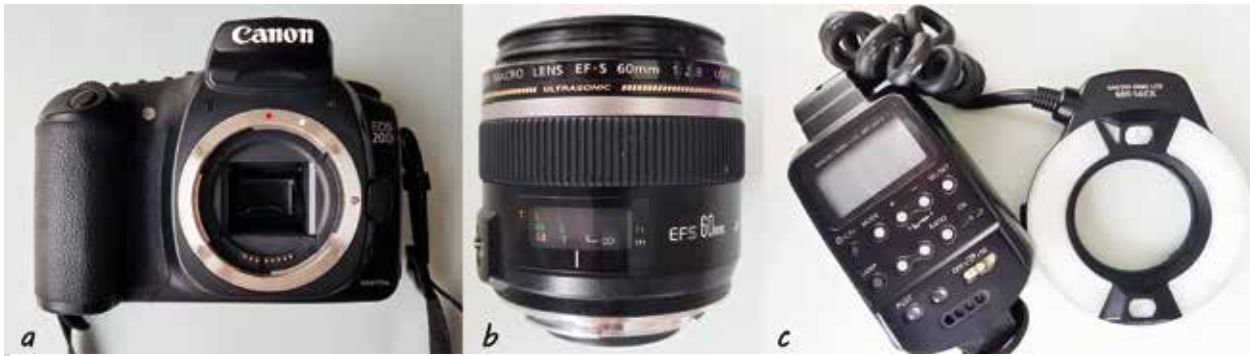
Abb. 2: Kameragehäuse (a), Makroobjektiv (b) und Ringblitz (c). Ein gutes Objektiv und die Anwendung eines Ringblitzes sind für die Dentalfotografie besonders zu empfehlen.
