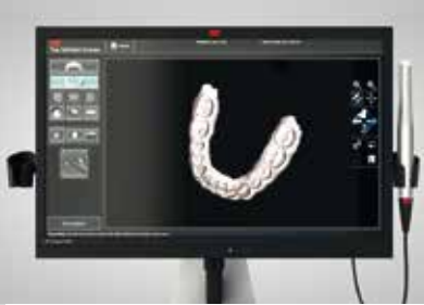
Abb. 8a: Digitalisierdaten eines gesamten Unterkiefers, 3M True Definition Scanner (Abb.: 3M)
