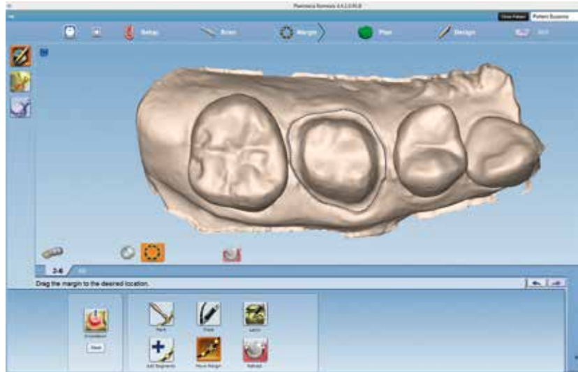
Abb. 10: Präparationsrandbestimmung mit der Software CADeasy von Planmeca (Abb.: Planmeca)
